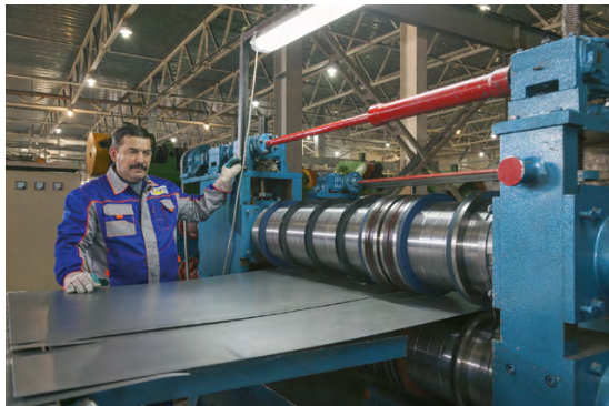
Резка металла на линиях продольной и поперечной резки
